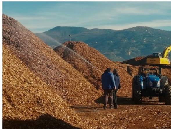
Figur 3 , sprutning av ett akrylbaserat ytbehandlingsmedel på en träflishög. Tagen från Picchi et al. (2024). CC BY.
