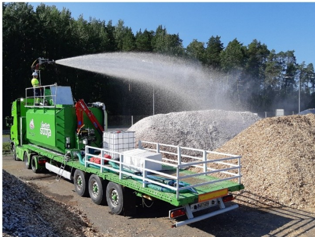
Figur 2 , täckande av träflishögar med Livotech Suoja®. Tagen från Prinz et al. (2022), källa: Luke/Robert Prinz. CC BY.
